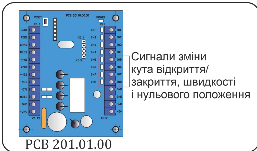
Рис. 19 – Сигнали зміни кута повороту на контролері PCB 201
